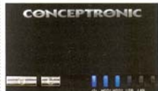
Los indicadores LED del frontal dan información del estado del NAS.
