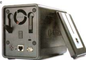
La instalación de los discos duros pasa por desmontar el frontal de la unidad, una tarea sencilla.
