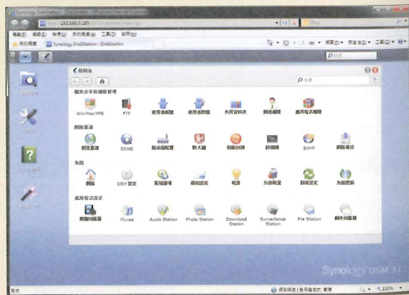
↑ 各家NAS的介面設計都不同，一般為檔案總管式的樹狀狀，但DSM為獨特的「桌面式」設計。
