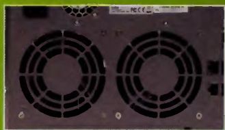
Deux gros ventilateurs sont nécessaires pour refroidir les disques durs et le processeur.
