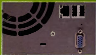
Avec le port VGA, l'interface de contrôle s'affiche et peut déceler des difficultés.
