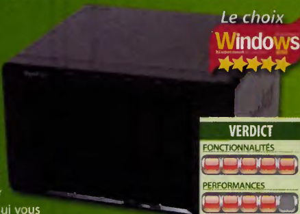
Les 5 baies en façade permettent d'échanger à chaud un disque en moins d'une minute.
