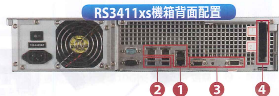
用於管理與資料傳輸的4個GbE埠①、4個用於連接週邊設備的USB 2.0埠②，以及2個用於連接擴充機箱的InfiniBand埠③，預留的10GbE網路卡擴充槽④。
