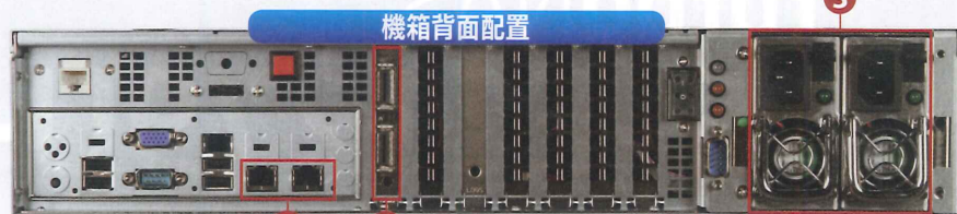
▲用於管理與資料傳輸的2個GbE埠①、安裝在擴充槽上的雙埠10GbE網路卡②，熱備援雙電源供應器③。
