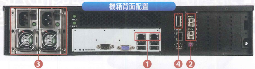
▲用於管理與資料傳輸的2個GbE埠①、安裝在擴充槽上的雙埠10GbE網路卡（選購）②、熱備援雙電源供應器③、硬體RAID卡的SAS擴充埠④。
