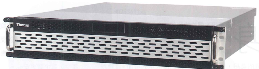
▲N8900的2U/8Bay容量的機箱正面帶有一個蓋板，並整合了1個Thecus專有的OLED LCD控制面板，IT人員可透過控制面板的簡易圖形介面，對系統執行基本的設定與管理。
