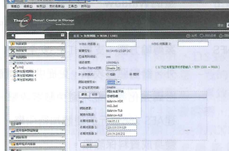
▲Thecus的軟體可提供6種頻寬聚合/負載平衡模式，管理者可藉以利用多個網路埠，建立自動失效切換、負載平衡或頻寬整合等應用。
