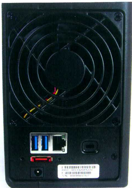
Solidna konektivnost: Osim 1 Gbitnog LAN-a tu su još čak 2 USB 3.0, eSATA, te s prednje strane SD card čitač i USB 2.0
