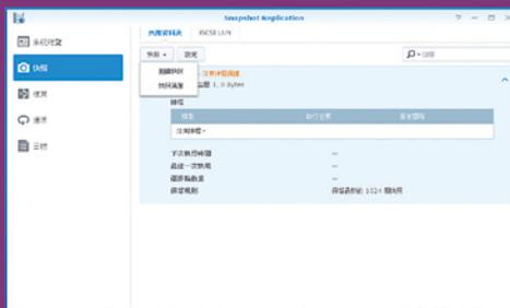
● DS1517+運行之DSM 6.1.1作業系統，對應Btrfs檔案系統，對應快照備份功能，安裝「Snapshot Replication」套件後即可建立快取排程。
